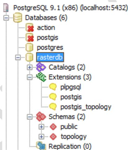
Enseguida se explicará cómo usar la herramienta *raster2pgsql* para importar una imagen Landsat-TM, compuesta por seis bandas espectrales, a la base de datos *rasterdb*. Sabemos que la imagen se encuentra referenciada en la proyección cartográfica UTM Zona 18N cuyo datum geodésico es WGS84. El nombre de la imagen es *recorte.tif* y su tamaño en disco es de 6.15 MB<sup>2</sup>. El Anexo 1 ofrece más detalles sobre esta imagen.
