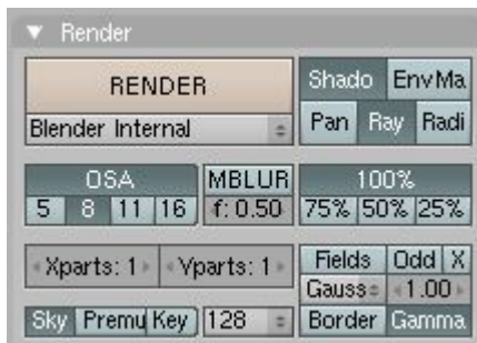
Figure xx: les options Shadow et Ray à activer, dans Blender
